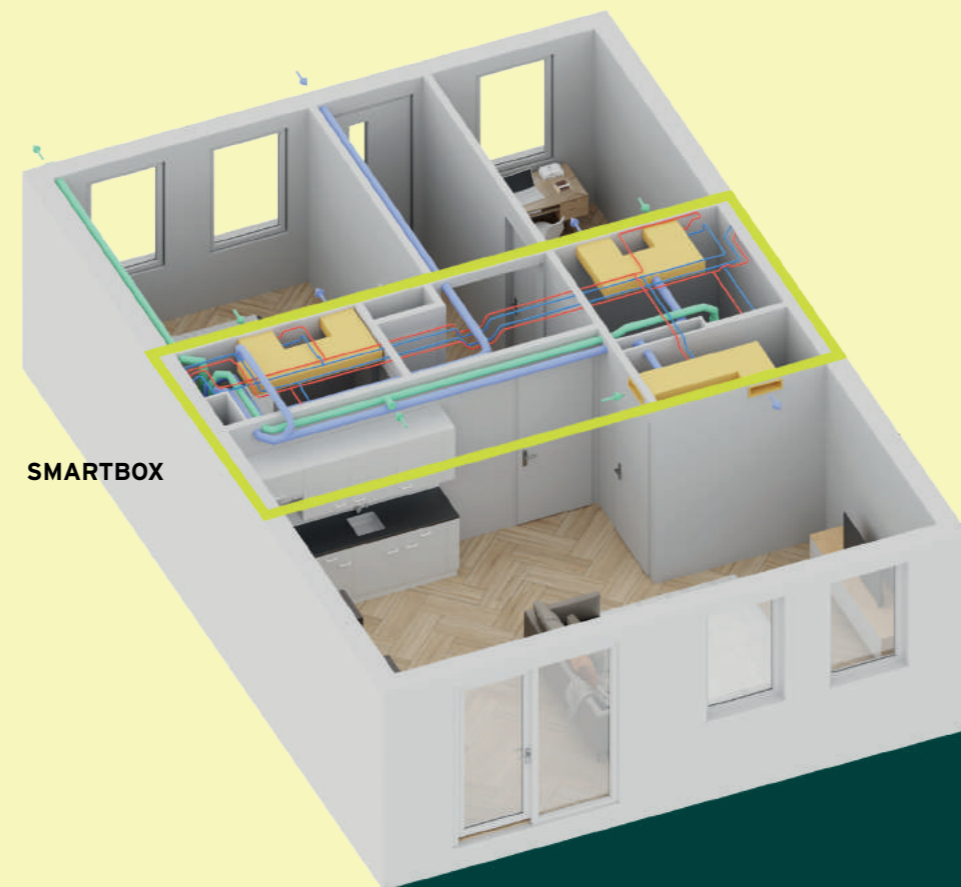
SMARTBOX EN INSTALLATIES
